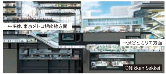
渋谷スクランブルスクエア アーバン・コア断面図 渋谷の回遊性向上の起点として機能します。
